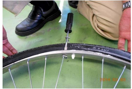
②④10cmほど離して曲工具をリムに掛けビードを嵌め平工具で外れないように支える
