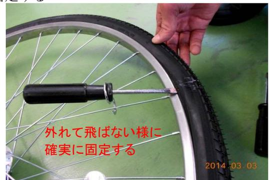
⑨7～8cm離して同じように曲工具で隙間を作り平工具を使ってビードを外す
